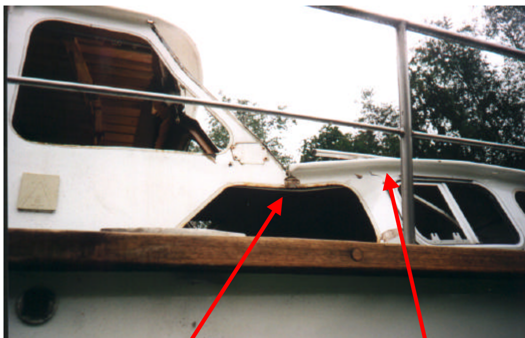
Kajütaufbau vom Deckshaus abgerissen und verformt
