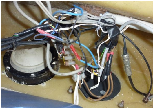
Bild: So sah es vorher hinter den Navigationsinstrumenten aus. Ein Wunder, dass es funktionierte.
