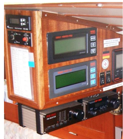
Bild: im Bild oben links mein Batteriemanager, leider kein gutes Bild (Foto umgewandelt von analog in digital)
